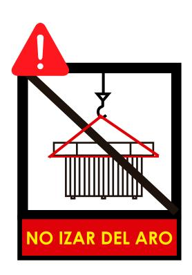
Para una correcta elevación de su Hiroki las sogas o eslingas deberán cubrir todo el barril. No izar sujetando solo el aro.
